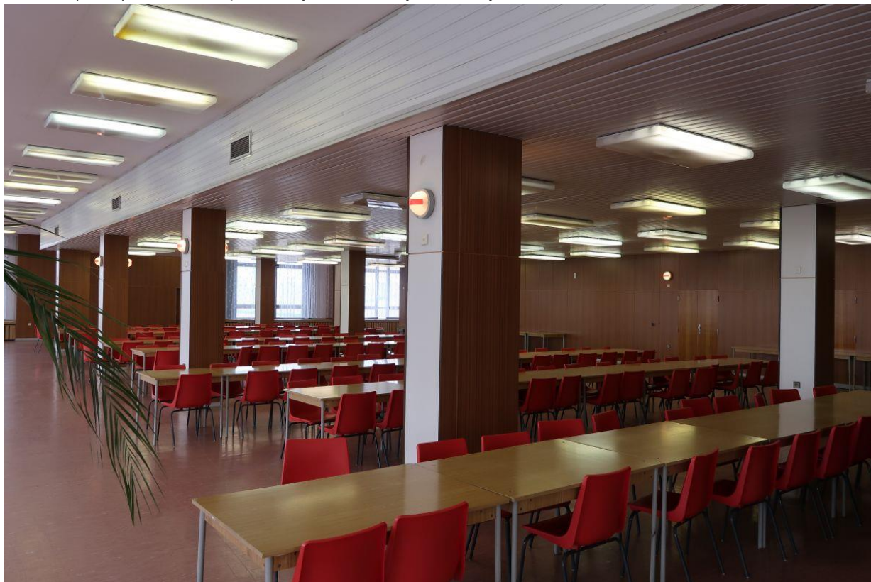
Jídelna (3.NP) – osvětlení přisazenými zářivkovými svítidly
